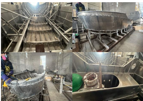
Foto No 185 a 188 –Bote No. 13 TUBERIA, FORRO, TAPA REGALA
