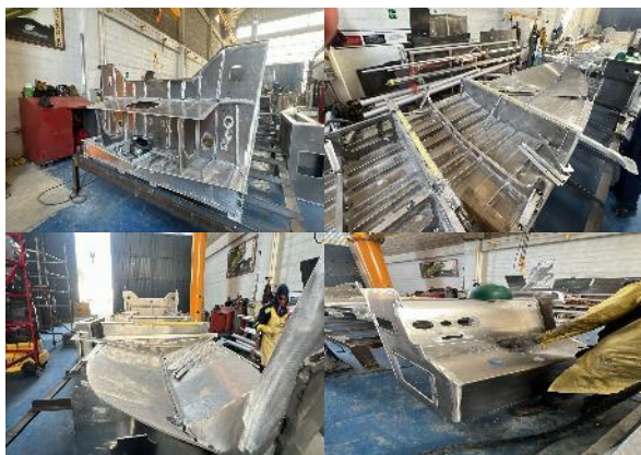
Foto No. 35 a 38 – Bote No. 11 Refuerzos, cuadernas y consola
