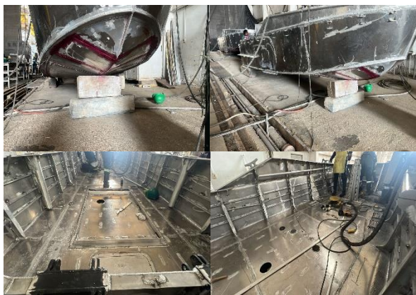
Foto No 173 a 176 –Bote No. 10 LAMINAS DE FONDO, CUBIERTA PRINCIPAL Y BASES DE LOS AFUSTES
