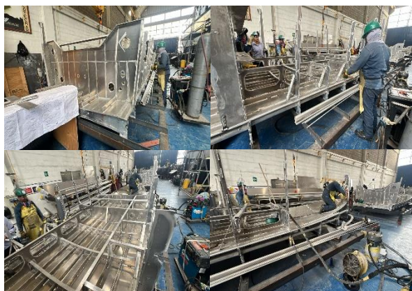
Foto No 197 a 200 –Bote No. 16 LAMINAS DE FONDO, REFUERZOS, CUADERNAS, MANPAROS
