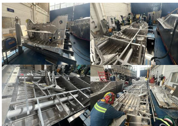
Foto No 197 a 200 –Bote No. 16 LAMINAS DE FONDO, REFUERZOS, CUADERNAS, MANPAROS
