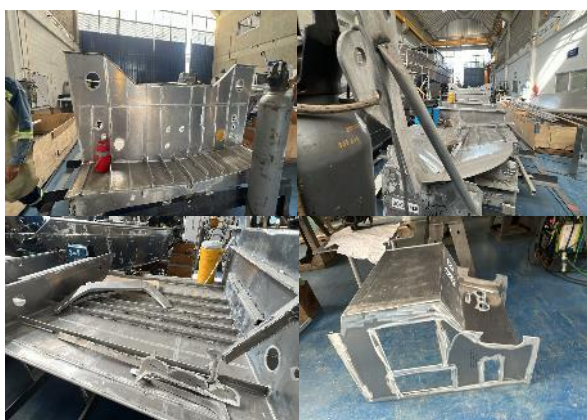
Foto No. 39 a 42 – Bote No. 12 Refuerzos, cuadernas y consola
