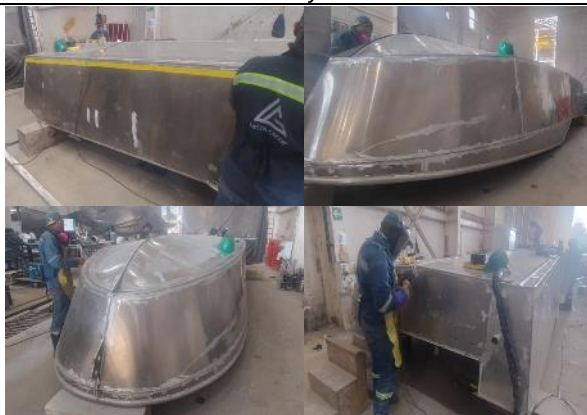
Foto No. 57 a 60 – Bote No. 9 refuerzos, tanque, bancada y volteo
