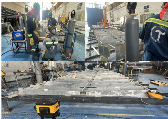
Foto No 151 a 153 –Bote No. 18 FABRICACIÓN Y ALINEACIÓN DE QUILLA
