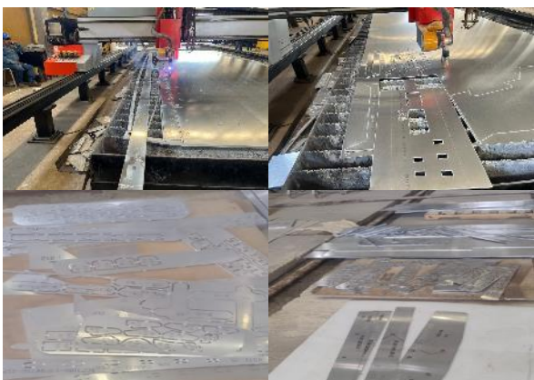
Foto No. 73 a 76 – Bote No. 14 y 15 Ronda y corte laminas
