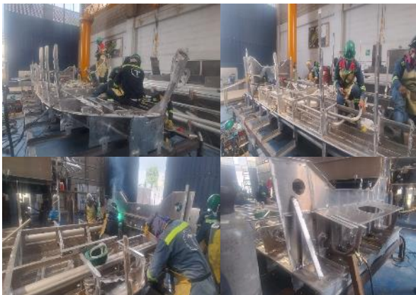
Foto No. 65 a 68 – Bote No. 11 Rrefuerzos, cuadernas y consola
