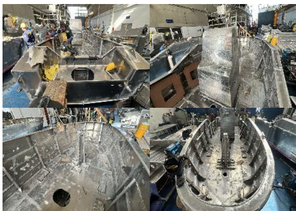
Foto No. 23 a 26 – Bote No. 8 láminas de fondo quilla y barras
