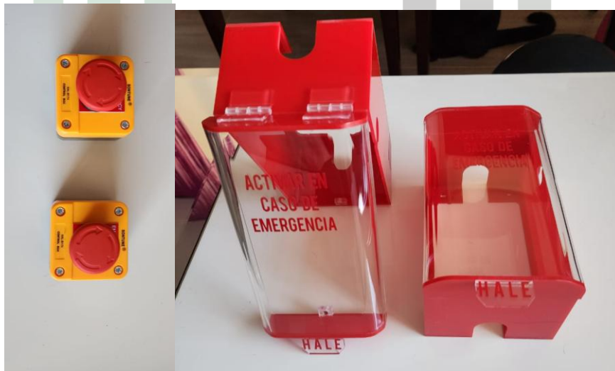
Botones y cajas de protección previa instalación.
