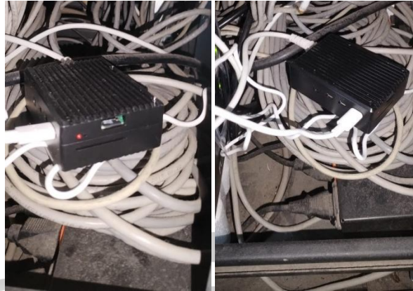
Raspberry sobre la cual se programó el sistema y se instaló en el Servidor del hospital.
