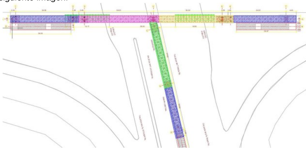
Figura 5 Secciones de instalación puente peatonal P8
