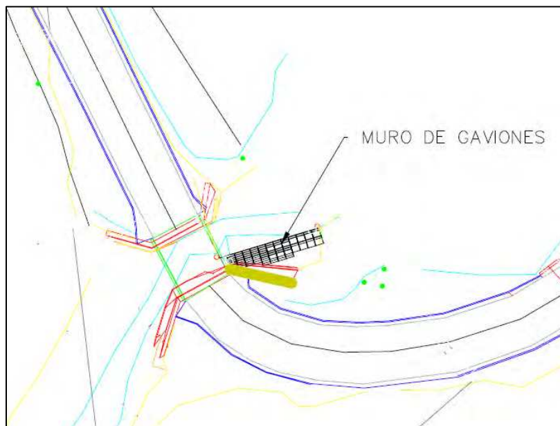
Ilustración 22 Muro de gaviones propuesto
