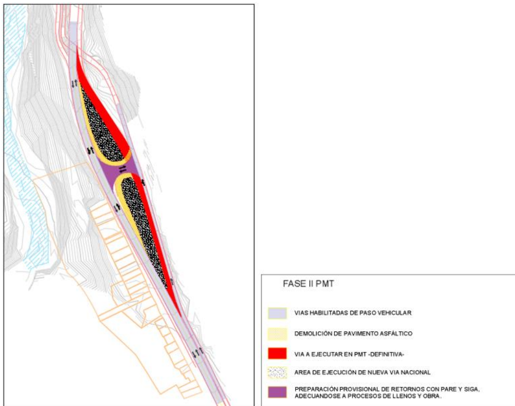
Figura 14. Maniobras - Fase 2 (estribo2)
