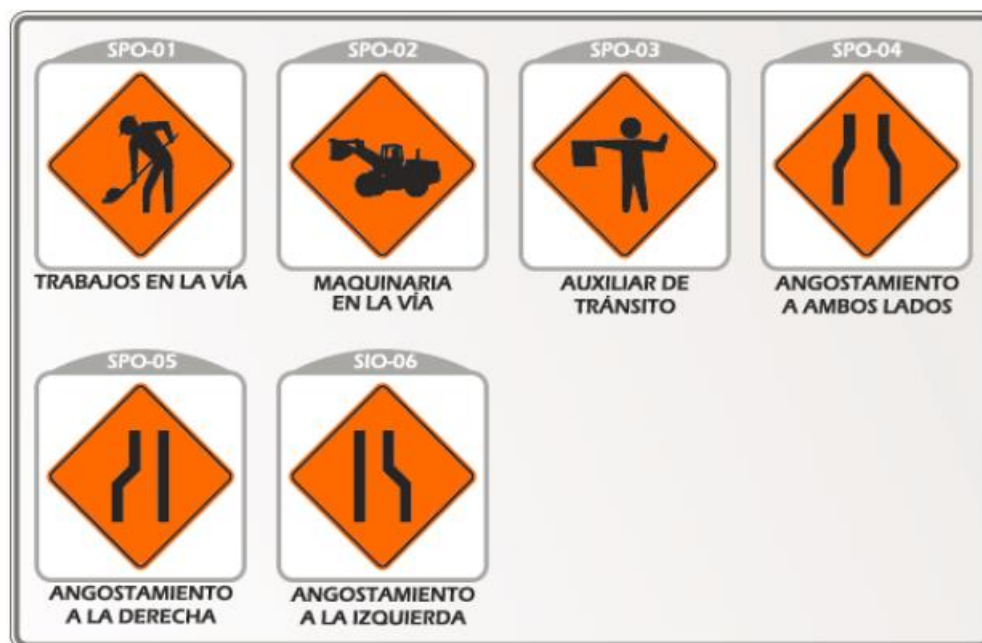
Figura 31. Señales preventivas en zonas de obra
