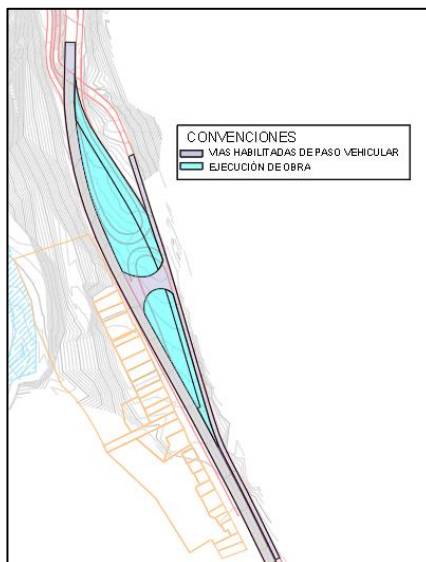
Figura 16. Vías habilitadas y zonas de obra – Fase 3 (estribo2)
