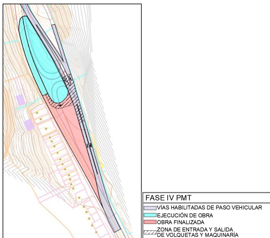
Figura 20. Maniobras - Fase 4 (estribo2).
