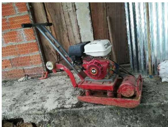
Fotografía No. 45. Manejo de maquinaria en obra, rana
