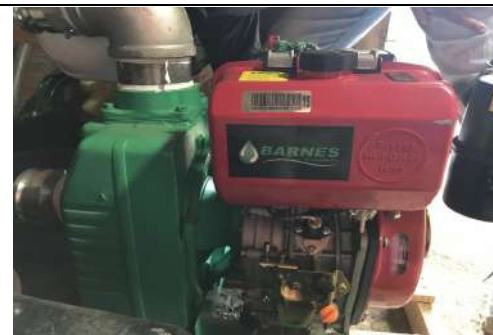
Motobomba de 11HP para desaguar la excavación del pozo séptico
