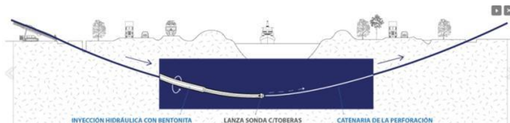
Figura 7 Esquema de la perforación piloto
