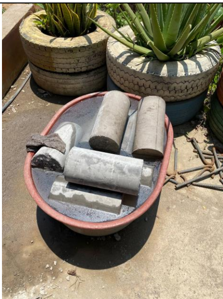
FOTO 109. 2025-03-08 CURADO DE MUESTRAS DE CONCRETO
