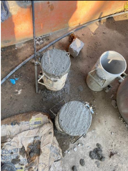
FOTO 113. 2025-03-08 TOMA DE MUESTRAS DE CONCRETO
