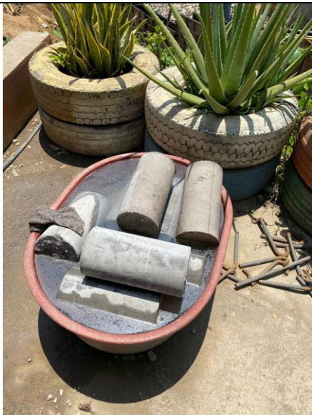
FOTO 111. 2025-03-08 CURADO DE MUESTRAS DE CONCRETO
