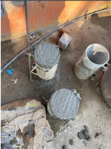
FOTO 113. 2025-03-08 TOMA DE MUESTRAS DE CONCRETO
