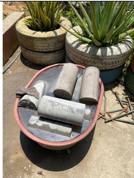
FOTO 112. 2025-03-08 CURADO DE MUESTRAS DE CONCRETO
