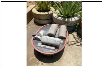
08/03/2025 TOMA Y CURADO DE MUESTRAS DE CONCRETO PARA ENSAYOS DE LABORATORIO AGUAS ABAJO DE BOX CULVERT K0+500, VÍA SAN PABLO - SIMITÍ, BOLÍVAR
