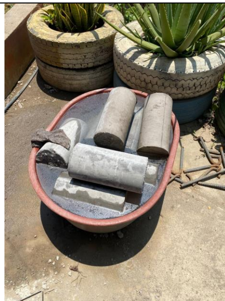
FOTO 110. 2025-03-08 CURADO DE MUESTRAS DE CONCRETO
