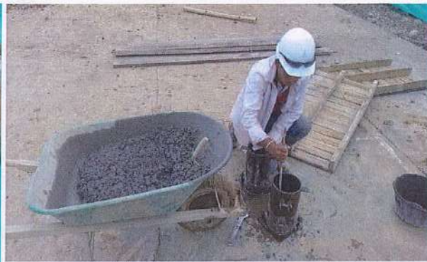
TOMA DE MUESTRAS DE CONCRETO PARA ENSAYO DE RESISTENCIA A LA COMPRESIÓN.
