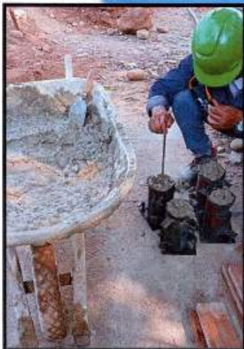
FOTO 3: Cilindros para pruebas de laboratorio
