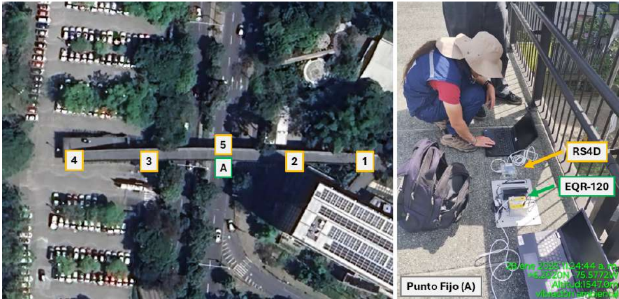
Figura 8.11: Izquierda: localización de puntos de medición de vibración ambiental en el puente peatonal de la Universidad EAFIT. Derecha: instalación simultánea de acelerógrafo de altas especificaciones de marca EQR-120 y acelerógrafo de bajo costo RS4D.
