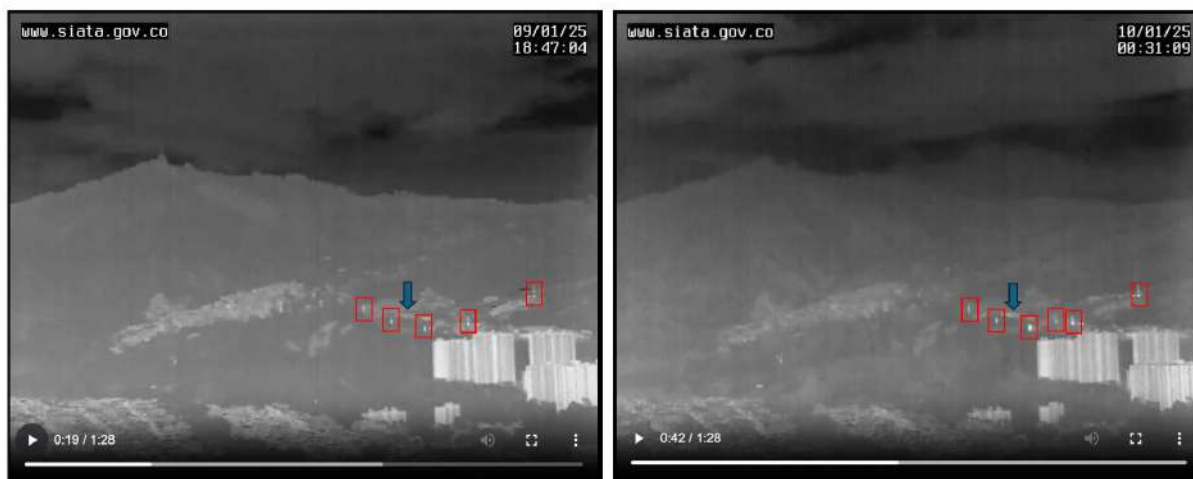
Figura 7.8: Imágenes de la cámara térmica ubicada en el Centro Comercial Viva de Envigado con visual hacia la vereda Los Gómez del municipio de Itagüí para diferentes momentos entre el 09 de enero a las 12:00 horas y el 10 de enero de 2025 a las 12:00 horas. Los cuadros rojos hacen referencia a posibles puntos fijos de emisión de contaminantes (chimeneas). La flecha azul muestra la ubicación aproximada de la estación.
