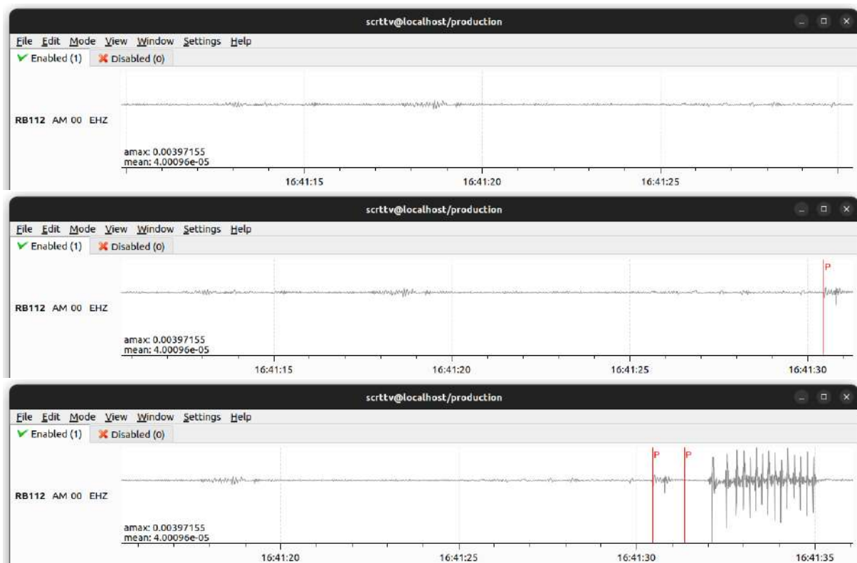
Figura 8.6: Detección automática de cambios de amplitud realizada por el módulo scautopick de Seis-ComP durante las pruebas controladas con equipos RaspBerry Shake 4D. Superior: ruido base registrado por el equipo antes de la generación de una perturbación en las amplitudes por un golpe sobre la mesa. Centro: primera detección (línea vertical roja) por cambio de amplitudes inducidas por el golpe. Inferior: segunda detección de cambio de amplitudes por golpes continuos sobre la mesa.
