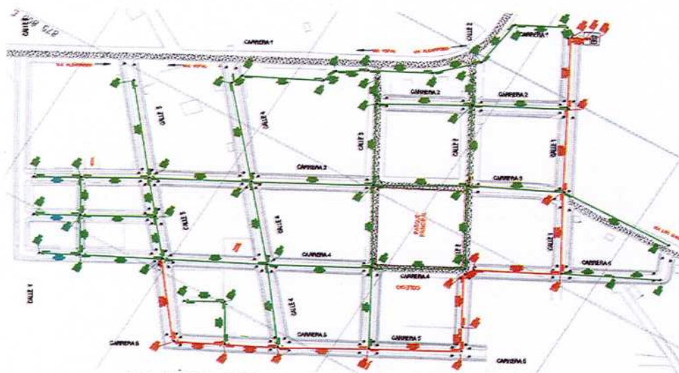
IMAGEN 3. RED DE ALCANTARILLADO SANITARIO.
