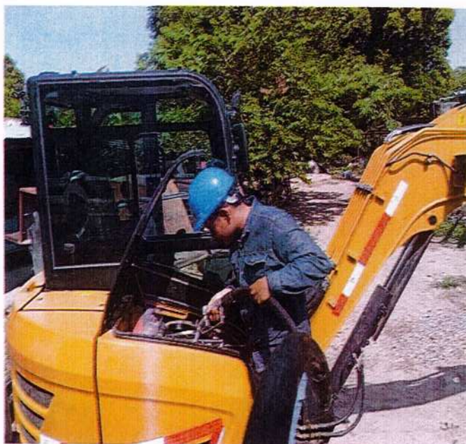
Fotografías 6.43 y 6.44. Tanqueo de maquinaria de forma segura
