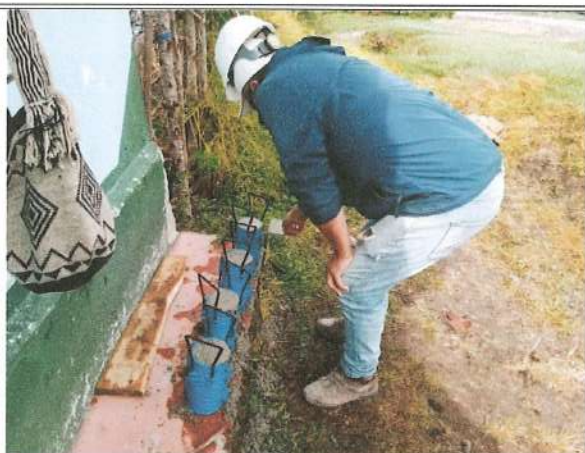
Foto No. 19. Toma de muestra de concreto, ensayos de laboratorio.
