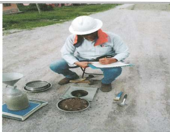
Foto No. 19. Toma de densidades, ensayo de laboratorio.
