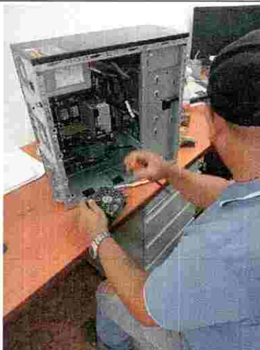
Limpieza de ventiladores y lubricacion
