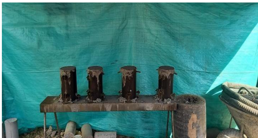
Ilustración 70. Toma de muestras concreto de Placa 3er nivel acceso principal
