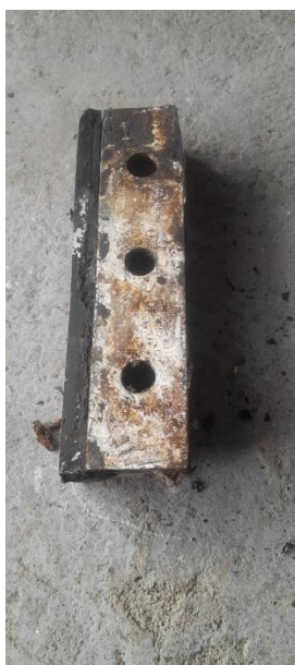
Daño de Guías del sistema
