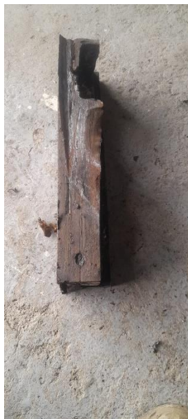
Daño de guía en porta calzos
