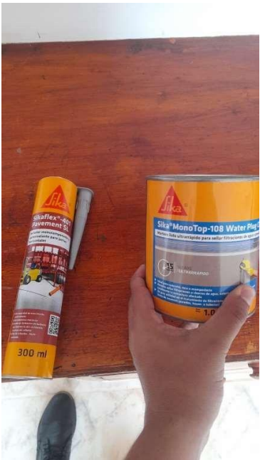
Productos utilizados por el contratista para realizar el sellado de las grietas de los edificios Quilla, Roda y Gavia
