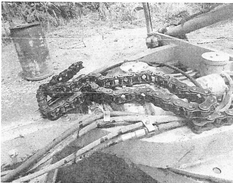
Desmonte y revisión de cadena de motoniveladora CAT120K
