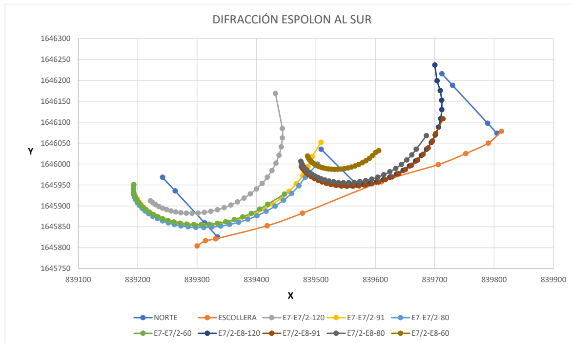
Figura 4. Equilibrio en planta para los oleajes que vienen del sur y se difractan en las cabezas de los espolones E7, E7/2.
