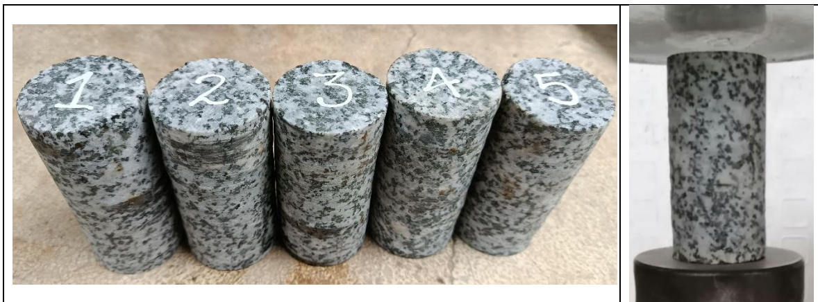
Figura 2. Muestras ensayadas mediante compresión simple Fuente: Contratista de Obra
