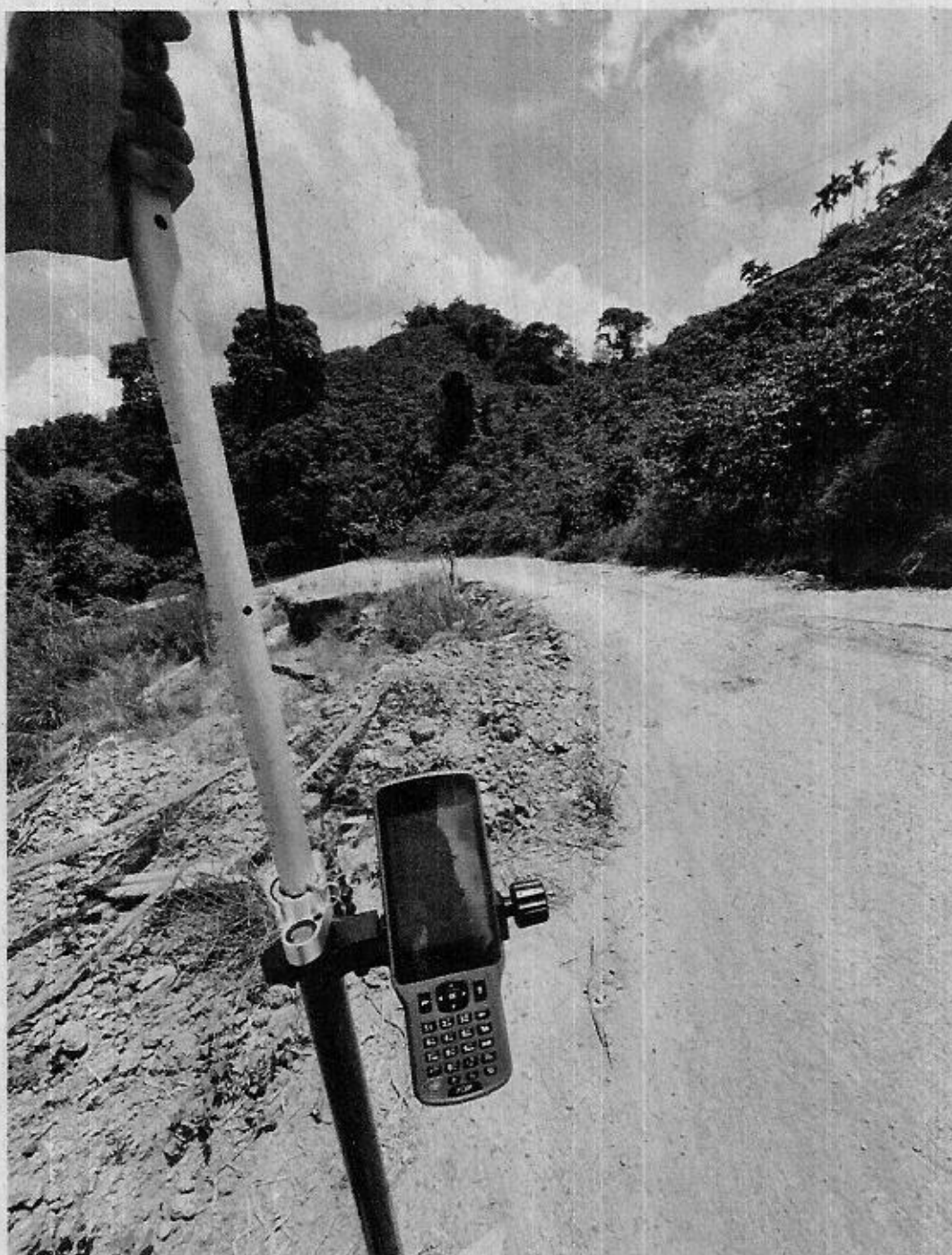
Recolección RTK en sitio crítico.
