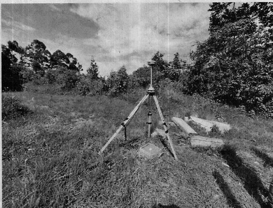
Imagen de georreferenciación de GPS 1 mediante doble medición de estático rápido
