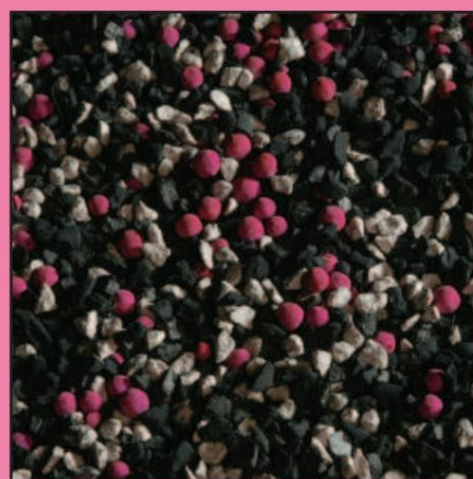
Medio de triple mezcla con carbón activado, alúmina impregnada y zeolita.
