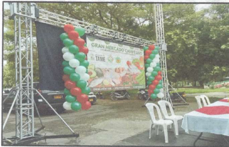
FOTO 98 - 101: Muestra la verificación de las especificaciones técnicas del ítem 1.1.10 "MERCADO CAMPESINO REACTIVACIÓN DE LA EMPRESA PLAZA DE MERCADO" en el marco de la ejecución del contrato de prestación de servicios No. 255 de 2025, se verifica el cumplimiento de la instalación de la pantalla modular led 3*2 mts de dimensión, que incluye estructura para el montaje tipo truss.
