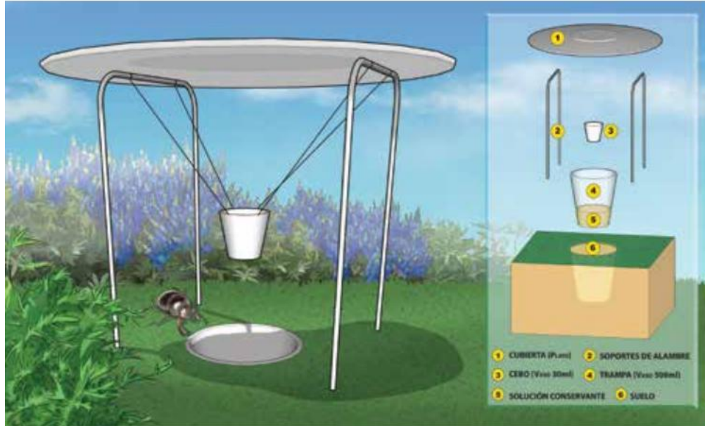
Figura 10. Diseño general de una trampa de caída letal. El plato debe incrustarse en el alambre para que este quede sujeto
