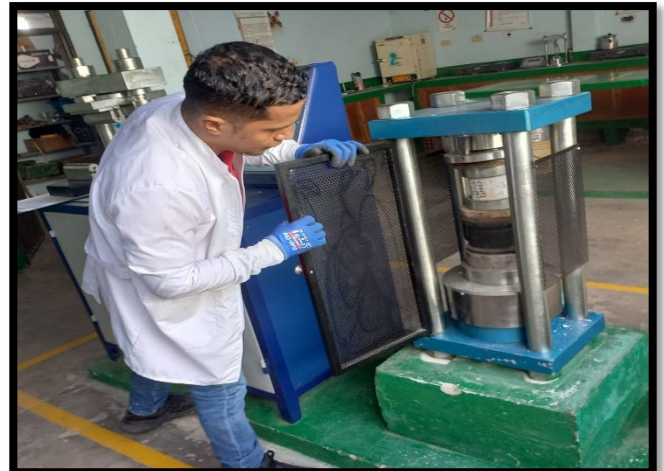
FOTOGRAFIA No.15 Y No.16 VERIFICACION Y FALLO DE CILINDROS EN RESISTENCIA DE CONCRETO.
