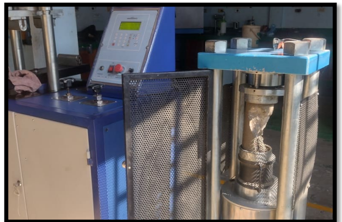
FOTOGRAFIA No.23 Y No.24 RESULTADOS DE FALLOS DE CILINDROS EN CONCRETO.
