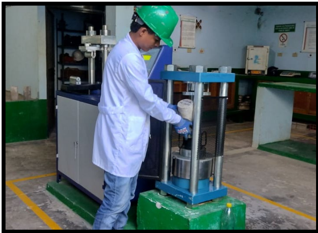
FOTOGRAFIA No.21 Y No.22 FALLO DE MUESTRAS DE CILINDROS EN CONCRETO EN LABORATORIO.
