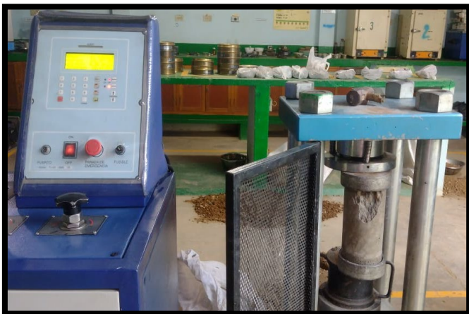
FOTOGRAFIA No.23 Y No.24 RESULTADOS DE FALLOS DE CILINDROS EN CONCRETO.
