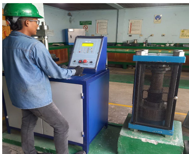
FOTOGRAFIA No. 33. Control de resistencia de cilindros en concreto de 3500 PSI.
