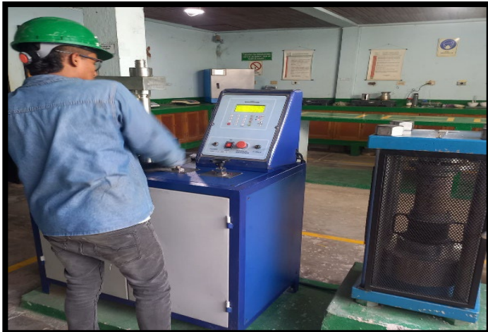
FOTOGRAFIA No.15 Y No.16 VERIFICACION Y FALLO DE CILINDROS EN RESISTENCIA DE CONCRETO.
