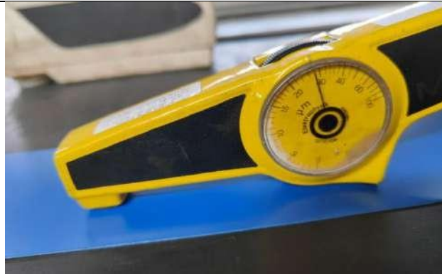
Medición del espesor seco de la pintura superior de la muestra.
