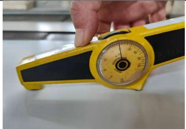
Medición del espesor seco de la pintura inferior de la muestra.
