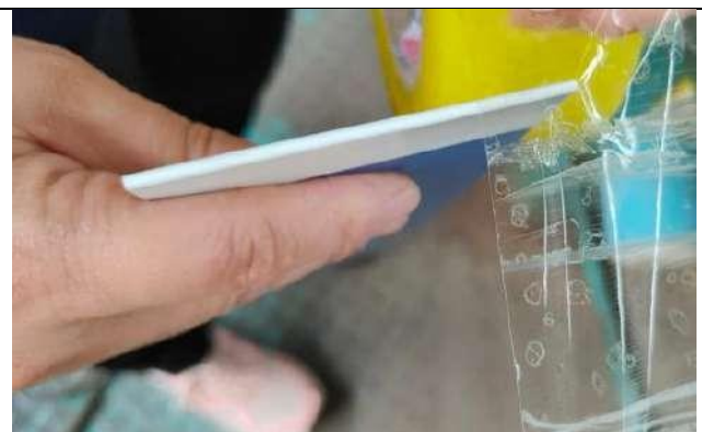
Mostrando la prueba de curvatura en T. Calidad 0T
