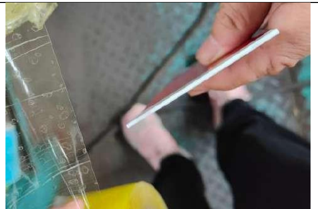
Mostrando la prueba de curvatura en T. Calidad 0T
