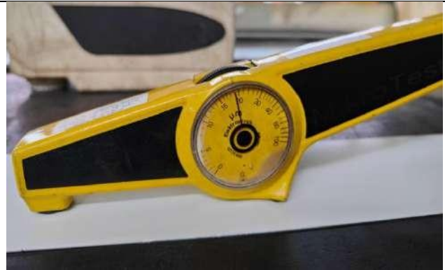
Medición del espesor seco de la pintura inferior de la muestra.
