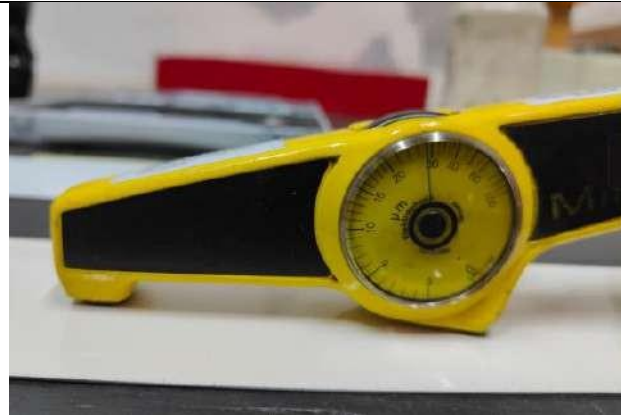
Medición del espesor seco de la pintura superior de la muestra.
