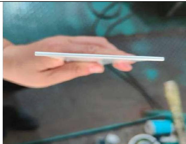
Mostrando la prueba de curvatura en T. Calidad 0T
