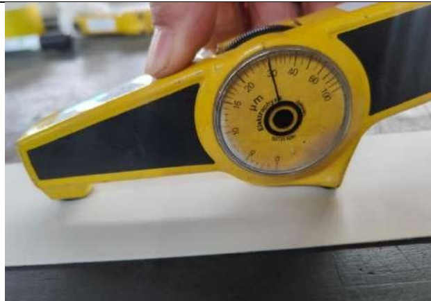
Medición del espesor seco de la pintura superior de la muestra.
