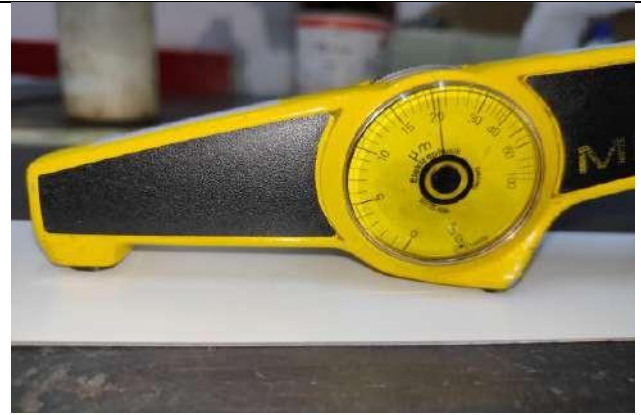
Medición del espesor seco de la pintura inferior de la muestra.
