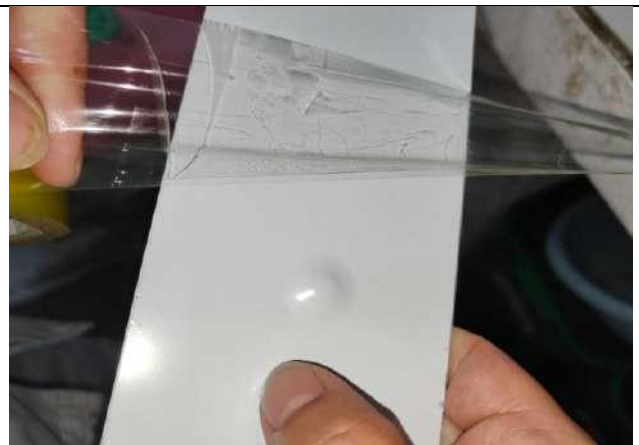
Mostrando la prueba de curvatura en T. Calidad 0T
