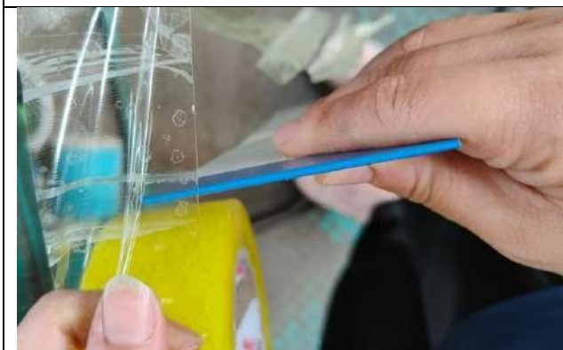
Mostrando la prueba de curvatura en T. Calidad 0T
