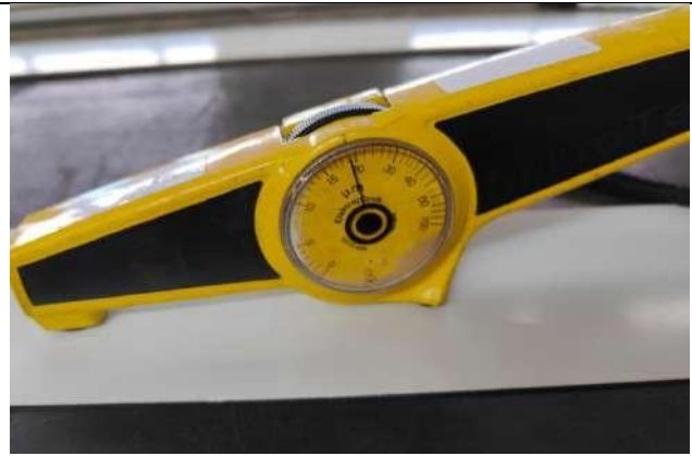
Medición del espesor seco de la pintura inferior de la muestra.
