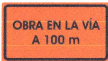
Ilustración 14. Señal informativa Aproximación a obra en la vía
