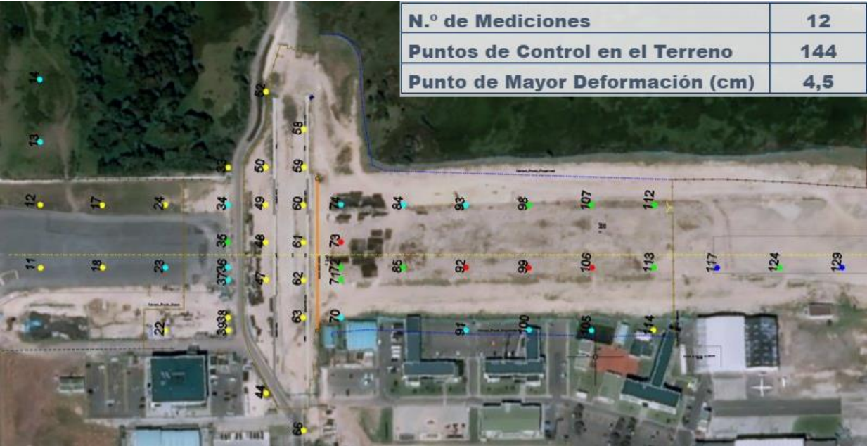
Figura 16 Ubicación puntos de control pruebas asentamientos primer semestre 2020 / Fuente: Aerocivil
