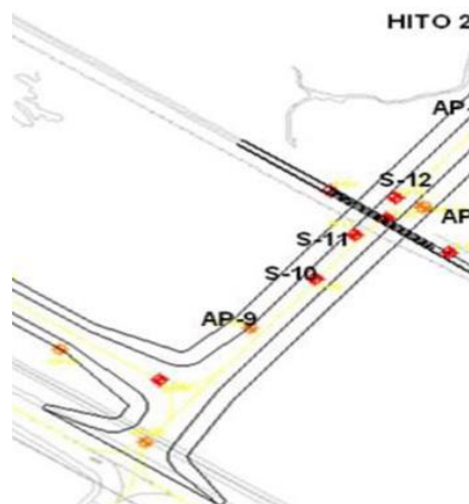
Figura 14 Zona 1 en el K0+250 al K0+450 donde se realizó exploración geotécnica en la etapa de estudios y diseños / Fuente: Consorcio Unido para el Dorado.
