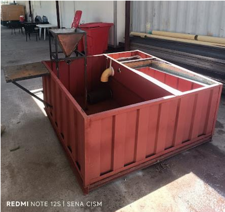
Tanque de lodos con tolva de mezcla
