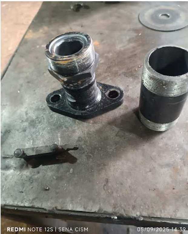
Adecuación de adaptador para bomba de lodos
