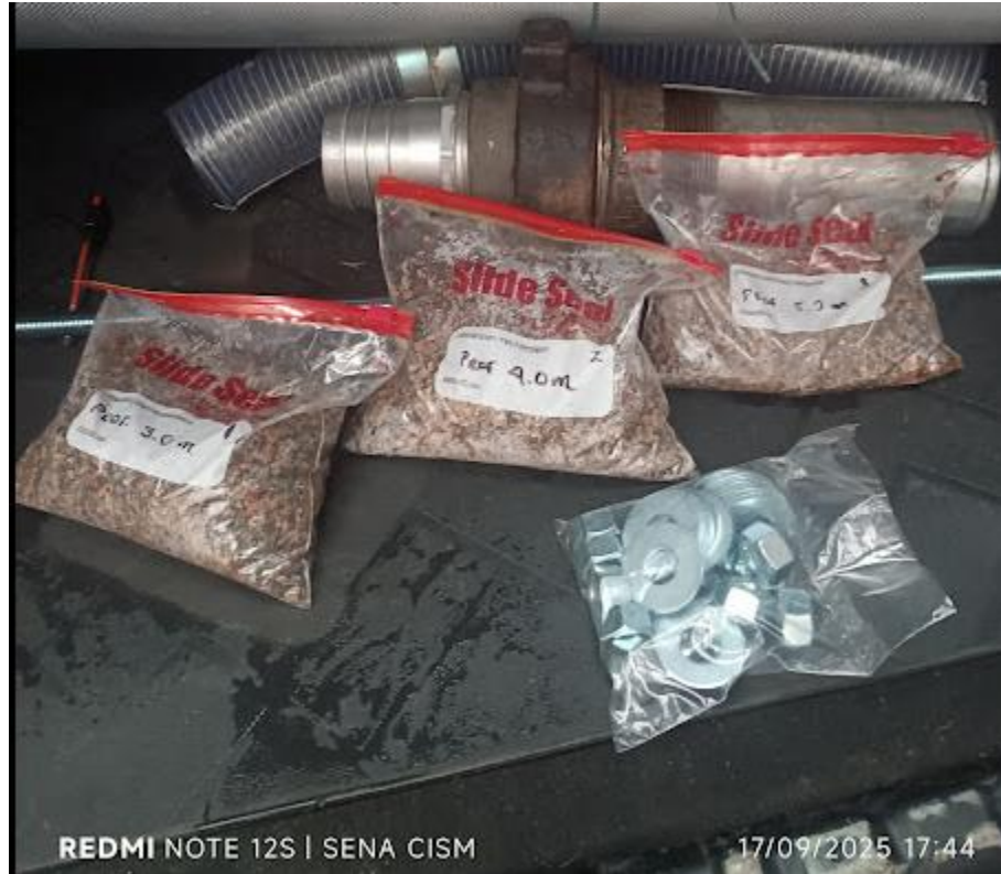
Muestras de material perforado a 3, 4 y 5 m
