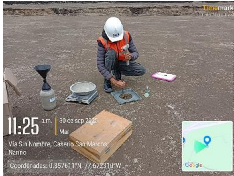
Figura 53 Ejecución ensayo de Cono de Arena in situ para determinar densidades
