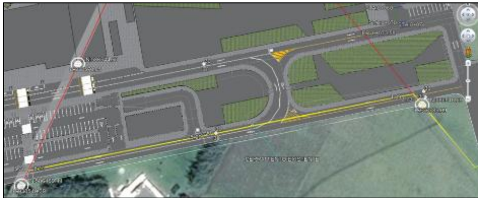
Figura 19 Desplazamiento del cerramiento definitivo del Aeropuerto, debido al predio vecino y a la vía provisional a construir.
