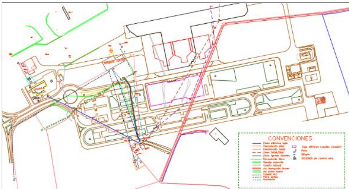
Figura 17 Redes y cajas de inspección existentes
