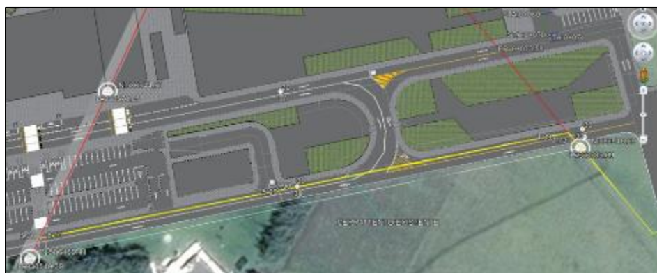
Figura 15 Desplazamiento del cerramiento definitivo del Aeropuerto, debido al predio vecino y a la vía provisional a construir.
