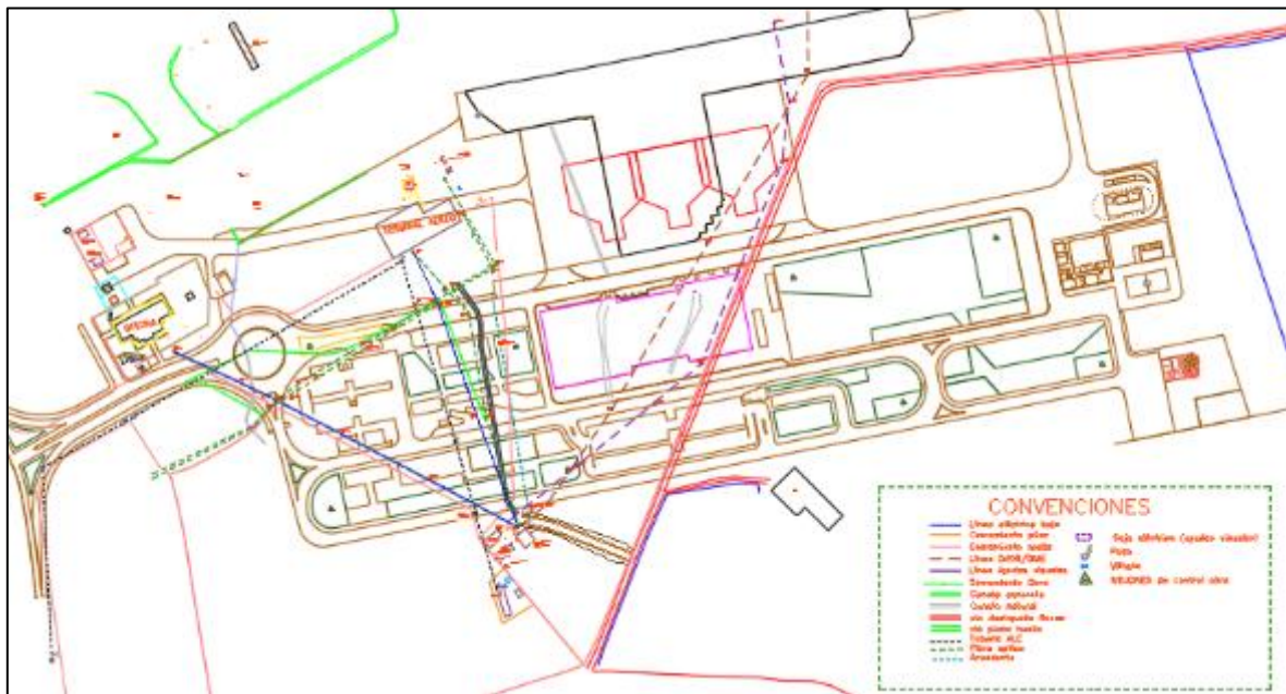
Figura 13 Redes y cajas de inspección existentes
