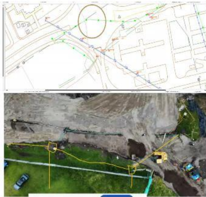
Figura 13 Redes y cajas de inspección existentes
