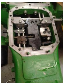
Observación: instalación del conjunto del eje de cambio de grupos y conjunto del eje de cambio de gamas
