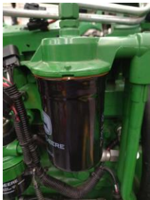
Observación:instalación filtro de aceite de motor
