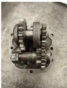
Observación: instalación eje, piñones, pines y rodamiento del Creeper
