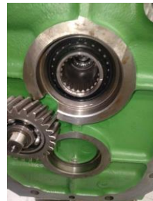
Observación: instalación retén trasero de la caja del embrague
