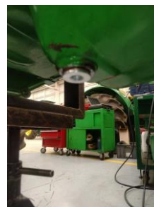
Observación:instalación tapón del Carter
