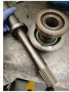
Observación: instalación rodamiento del eje hueco e instalación de rodamientos del conjunto de liberación del embrague
