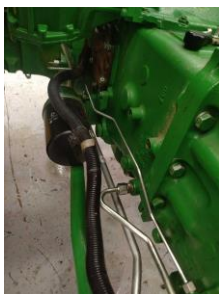
Observación: instalación tuberías de los frenos
