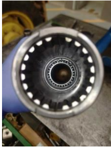
Observación: instalación del retenedor y rodamiento del eje hueco
