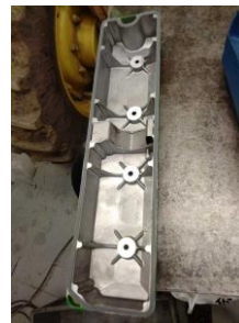
Observación:instalación junta del tapa válvulas
