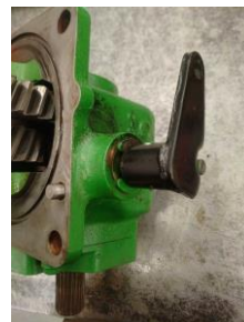
Observación: instalación palanca y pasador elástico de la caja de la transferencia
