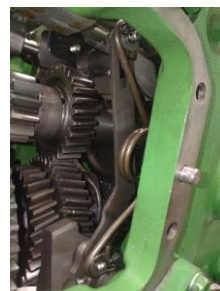
Observación: Instalación trinquete de parqueo
