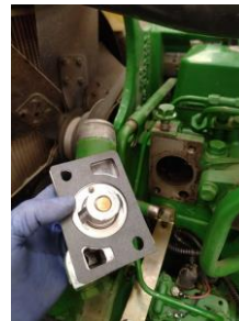
Observación:instalación de la junta y termostato
