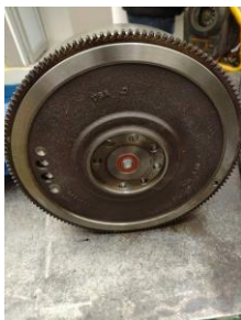
Observación: instalación rodamiento del volante
