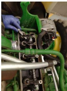
Observación:se realiza calibración de válvulas
