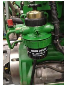
Observación:instalación filtro de combustible
