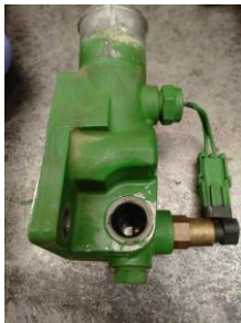
Observación:instalación sello de la caja del termostato
