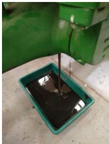
Observación: drenaje aceite del puente delantero
