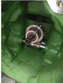
Observación: Armado e instalación de eje, conjunto de liberación del embrague y horquillas del embrague
