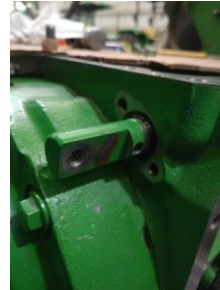
Observación: instalación retenedor de la palanca de la traba del diferencial
