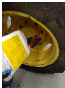
Observación: Llenado de aceite de los cubos
