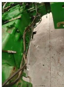
Observación: instalación varillaje del embrague de la TDF
