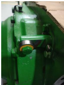
Observación: instalación rodamiento de la traba del diferencial
