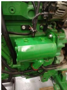
Observación:instalación bomba hidráulica
