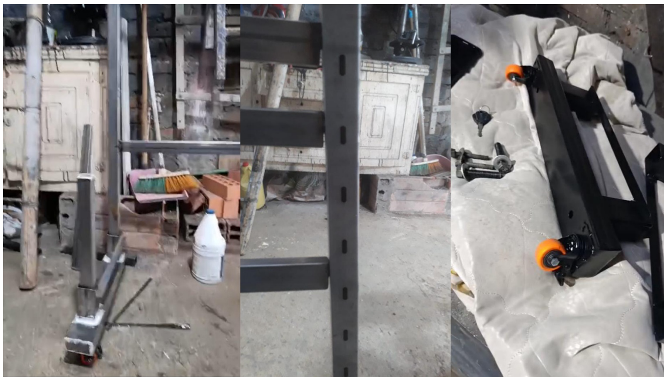
Imagen 15. Producción de estructura de metal “diseño y producción de stand modular”.
