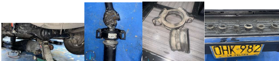
Desmontar cardan principal para cambio de soporte cardan, cambio de bujes de los amortiguadores.
