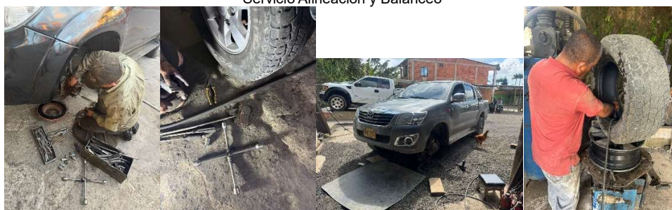
Mantenimiento y cambio de pastillas freno, servicio montaje de llantas.
