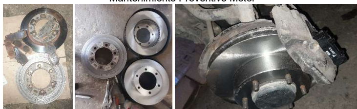
Desmontar llantas delanteras para mantenimiento y cambio discos de freno los cuales se encontraban en su máximo nivel de trabajo.
