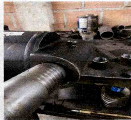
Desinstalar cilindro hidráulico de volteo, cambio de sellos (empaquetadura) e instalación
