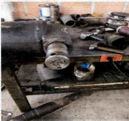
Desinstalar cilindro hidráulico de volteo, cambio de sellos (empaquetadura) e instalación
