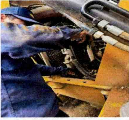
Mantenimiento preventivo del motor, consistente en el cambio de aceite lubricante y de filtros del motor 1
