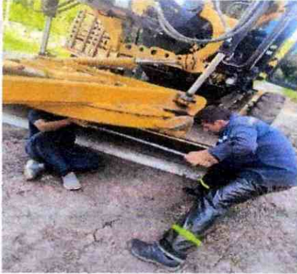
Instalación de insertos planos y curvos y ajuste de la tornamesa 2
