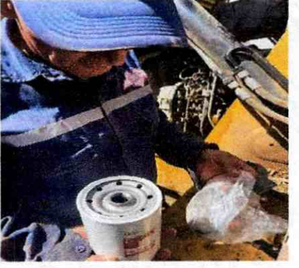
Mantenimiento preventivo del motor, consistente en el cambio de aceite lubricante y de filtros del motor 1
