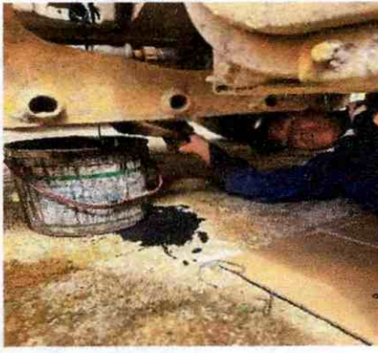
Mantenimiento preventivo del motor, consistente en el cambio de aceite lubricante y de filtros del motor 1
