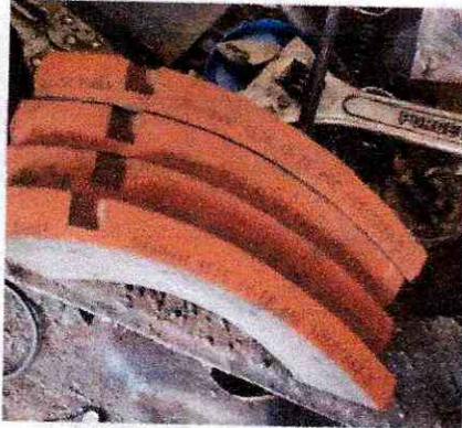
Cambio de bandas de asbesto remachadas del sistema de frenado
