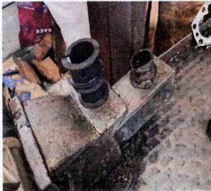
Extracción y reposición bujes caña de la dirección
