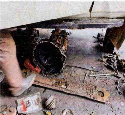
Desmontar y montar caja de velocidades y cambiar Kit de embrague
