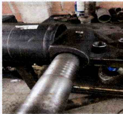
Desinstalar cilindro hidráulico de volteo, cambio de sellos (empaquetadura) e instalación
