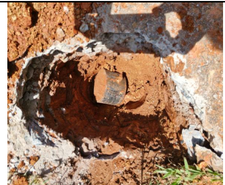
Toma molde CBR Apique 3 Unidad Recreativa La Estrella
