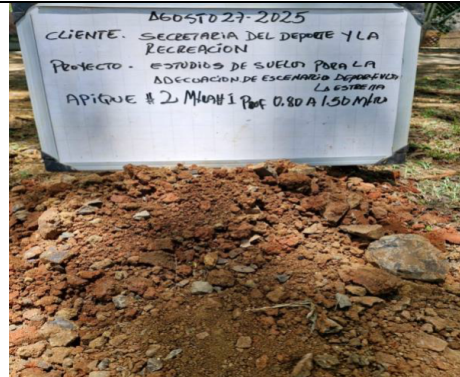
Toma molde CBR Apique 2 Unidad Recreativa La Estrella
