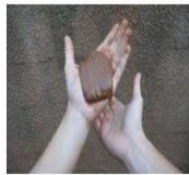
Imagen n°3. Prueba de dilatancia golpeándola debajo de la mano.
