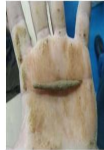
Imagen n°5. Rollitos para la prueba de tenacidad.
