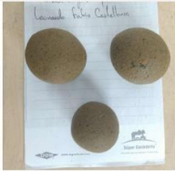
Imagen n°1. Esferas para prueba de resistencia en seco.
