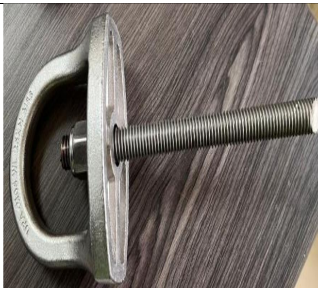
FOTO No 17: La interventoría ARQUITECTURA URBANA LTDA., revisa y verifica el ingreso de ANCLAJES DIPALL para trabajo seguro en altura edificio de la ALCALDÍA LOCAL DE PUENTE ARANDA.
