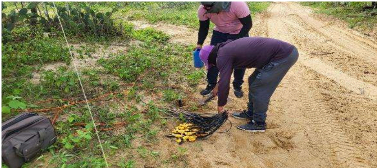
Figura 1 - 14 Clavado de electrodos
