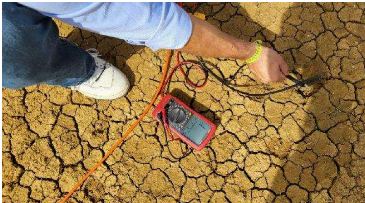
Figura 1 - 20 Control de calidad, por discontinuidad, Tomografía 1
