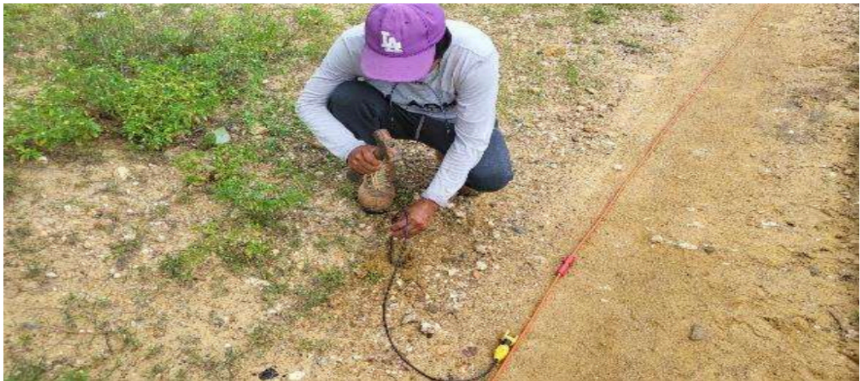
Figura 1 - 07 Clavado de electrodos
