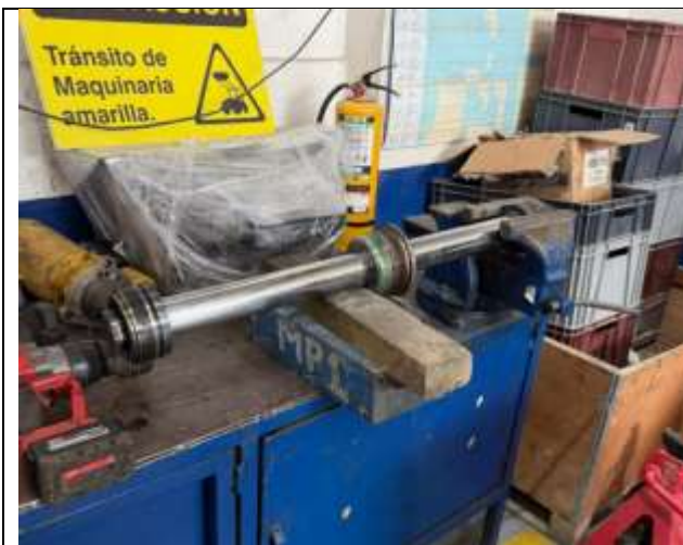
6 Empaquetadura cilindro de arrastre con mano de obra.
