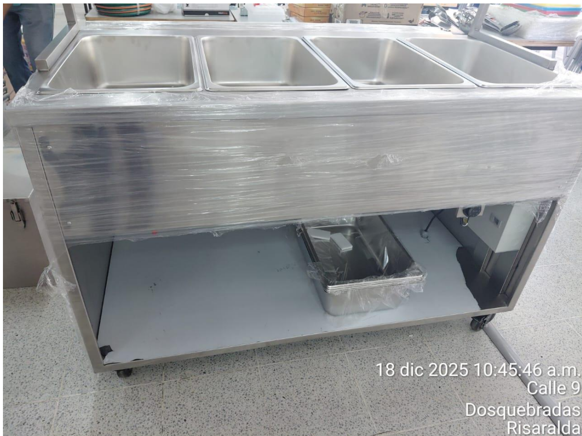
Ilustración 1 BAÑO MARÍA INSTALADO
