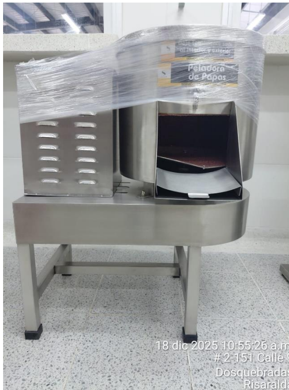
Ilustración 10 pelador de papas industrial 1 capacidad 25 kg
