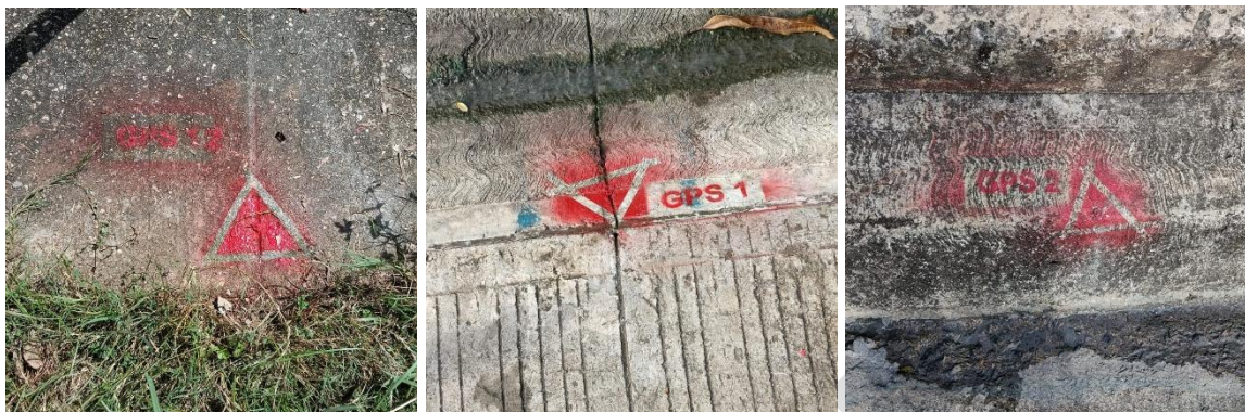
Ilustración 3-4-5 Materialización de vértices de referencia GPS 12, GPS 1 y GPS 2 en zona dura.
