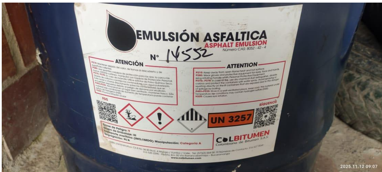
Ilustración 7 Producto aplicado en juntas de pavimento en concreto como mezcla bituminosa
