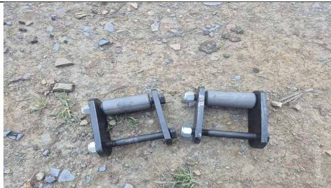
JUEGO DE BALANCINES DE LOS MUELLES DELANTEROS (INCLUYE BUJES Y PASADORES)
