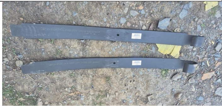
JUEGO DE BALANCINES DE LOS MUELLES DELANTEROS (INCLUYE BUJES Y PASADORES)
