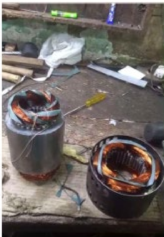
Imagen 28 a 33. Se realiza mantenimiento general y embobinado de bombas
