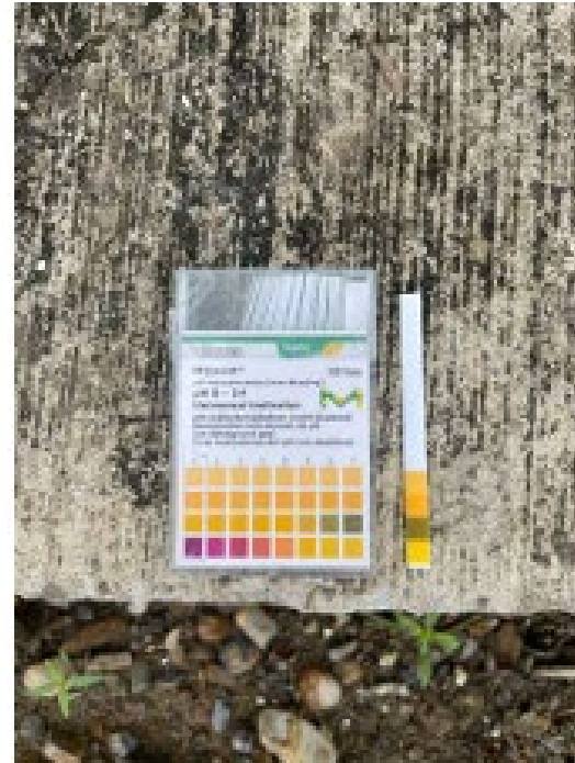
Imagen 18 y 19. Toma de pH en afluente, resultado pH 7.
