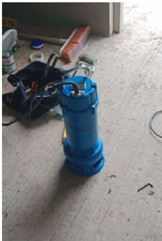
Imagen 36. Suministro de electrobombas sumergibles
