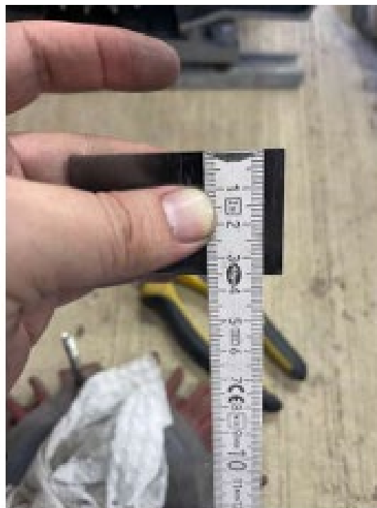
Imagen 27. Verificación de desgaste de paletas de carbono. Resultado 34 mm. (Deben medir mínimo 28 mm).
