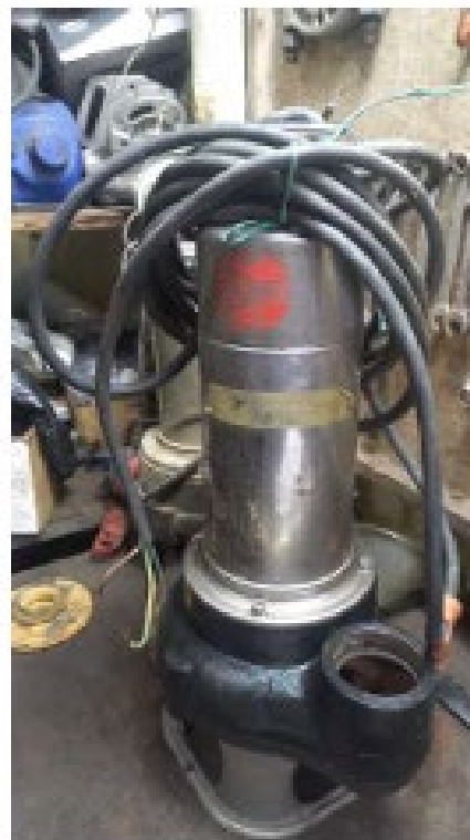
Imagen 28 a 33. Se realiza mantenimiento general y embobinado de bombas
