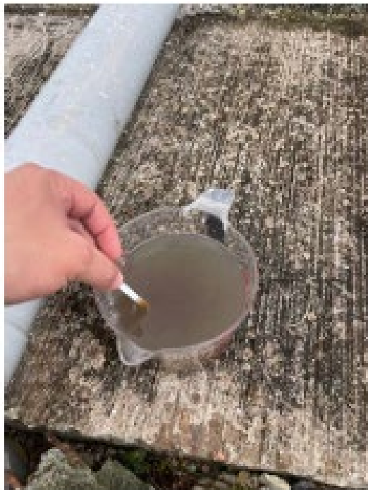
Imagen 18 y 19. Toma de pH en afluente, resultado pH 7.
