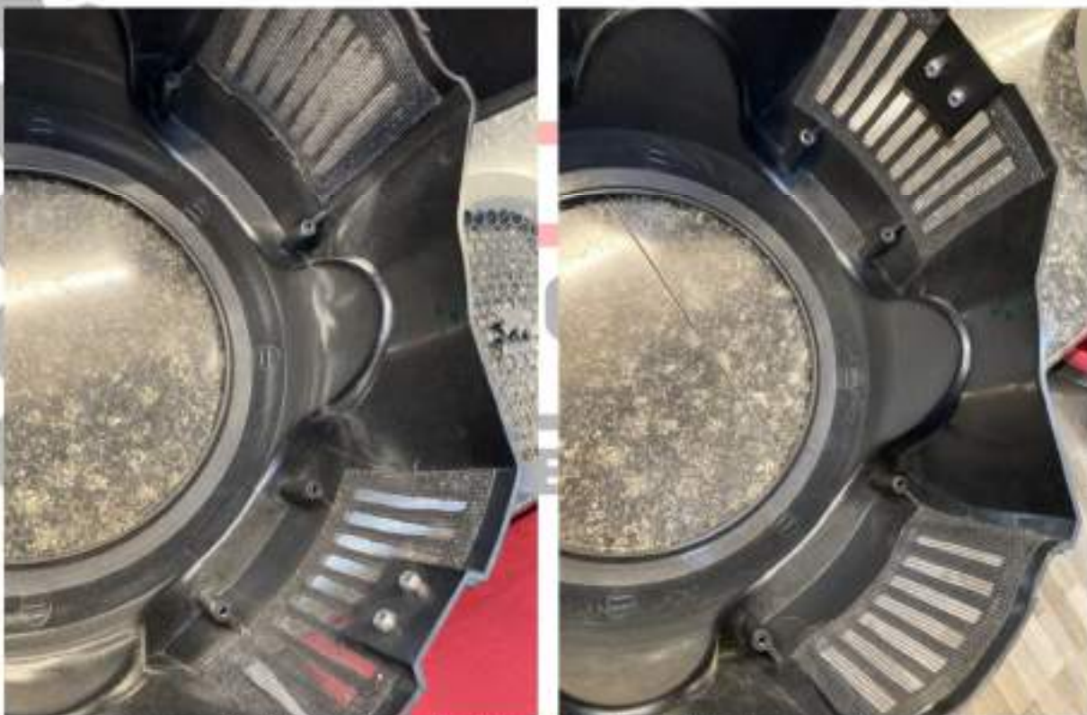
Imagen 1. Antes y después, limpieza de cubierta trasera de cabeza.
