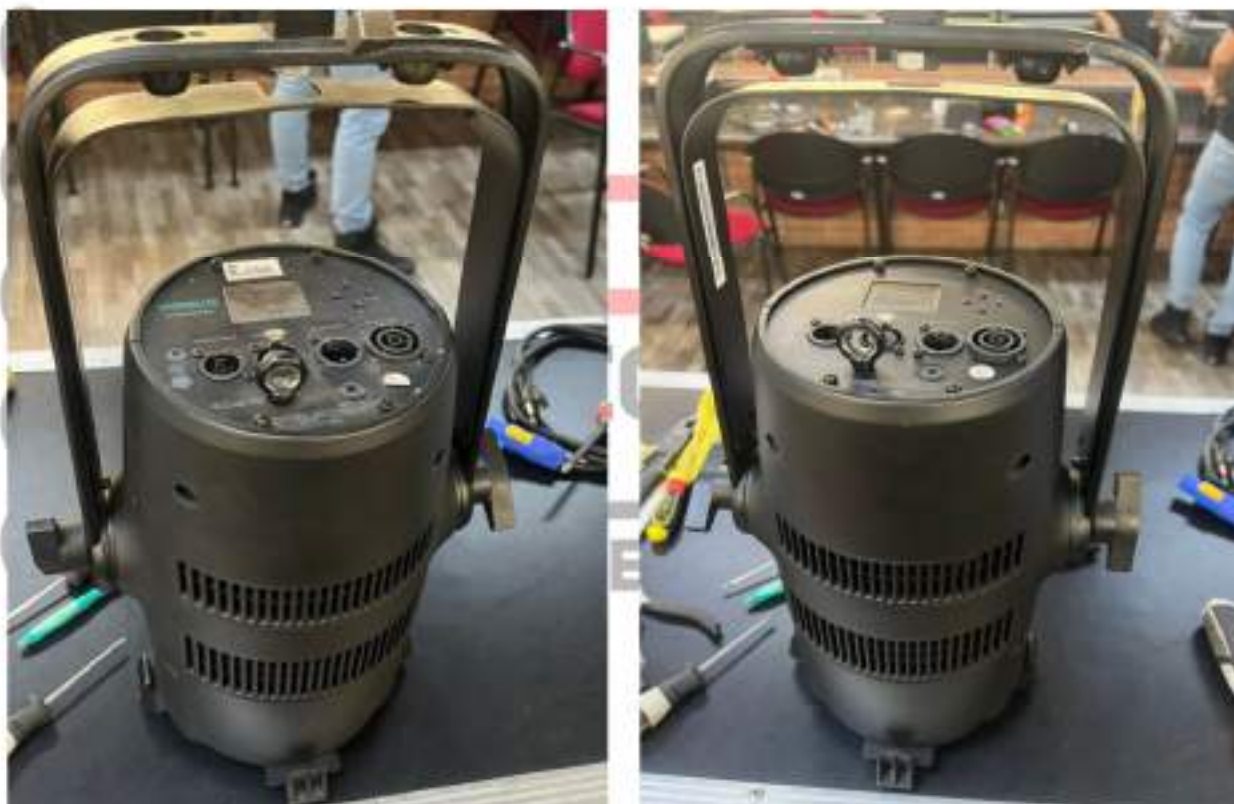
Imagen 11. Antes y después de la limpieza de la carcasa externa de los PAR LED Vari*Lite VL800 ProPAR
