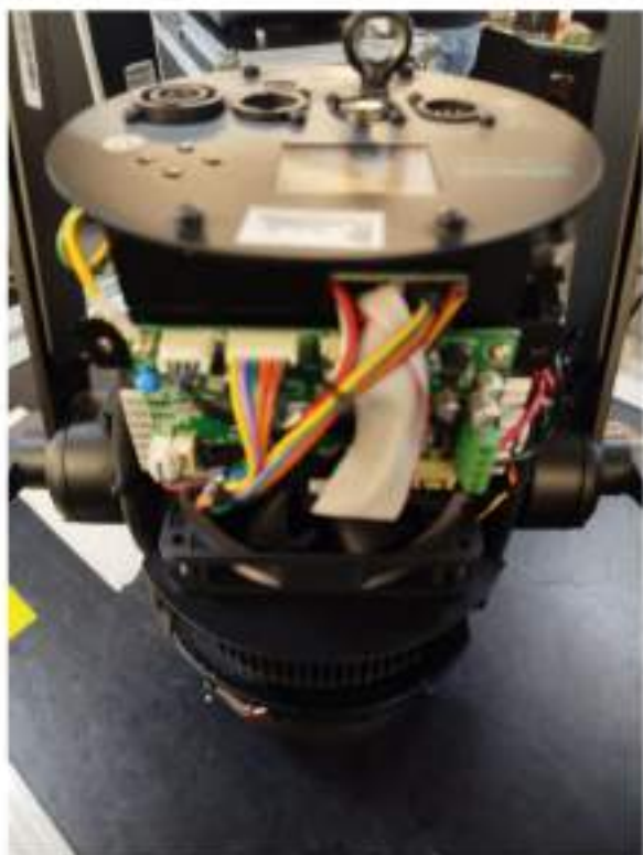
Imagen 11. Antes y después de la limpieza interna de los PAR LED Vari*Lite VL800 ProPAR
