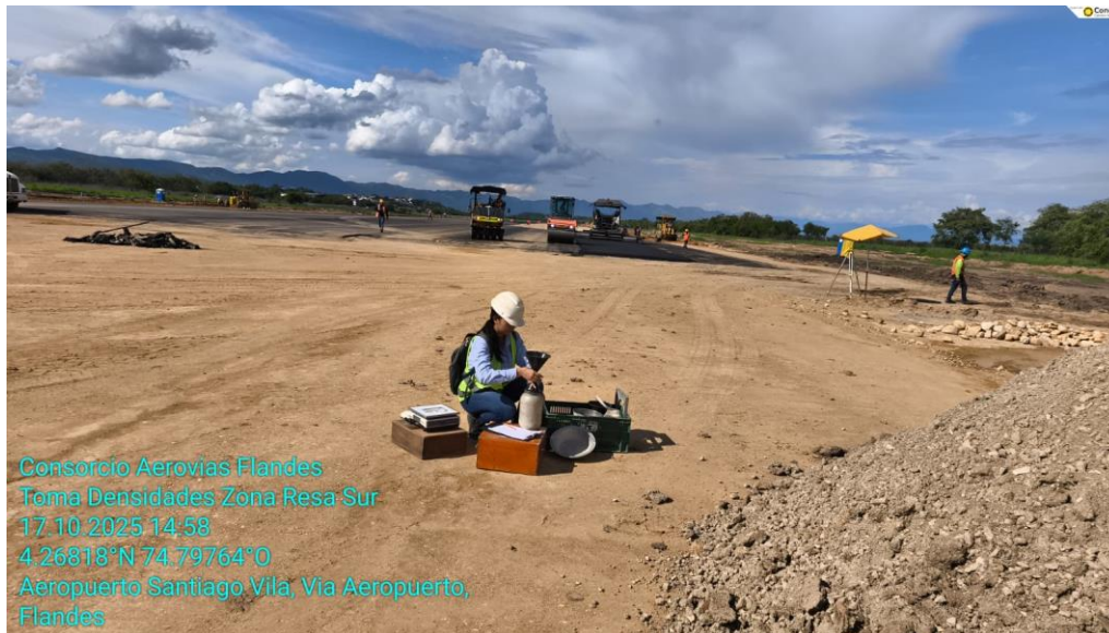
Ilustración 28 Toma de densidades en capa de afirmado RESA SUR
