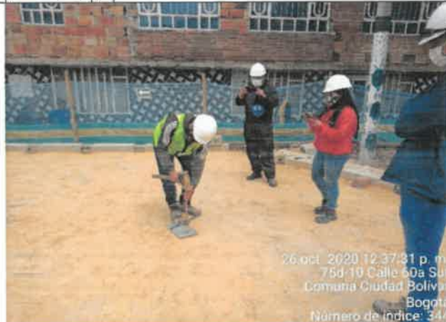
FOTO No. 178. Se revisa y verifica la ubicación del densímetro nuclear por parte de la interventoría ARQUITECTURA URBANA LTDA., parque LAS HUERTAS 19-038
